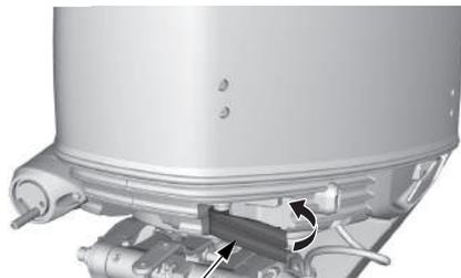
ENGANCHE DE LA CUBIERTA DEL MOTOR
