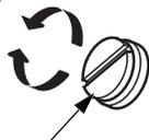
AJUSTADOR DE FRICCIÓN DE LA PALANCA DE CONTROL
