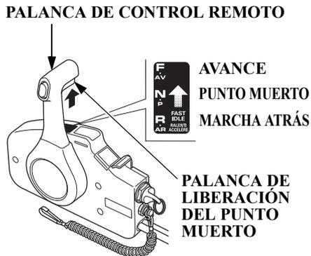
Cambiar a marcha adelante, marcha atrás o punto muerto y el ajuste de la velocidad del motor puede realizarse con la palanca de control remoto. Es necesario tirar de la palanca de liberación de punto muerto para operar la palanca de control remoto.
