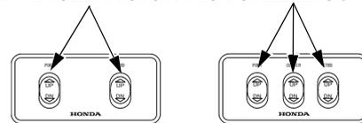
1. Presione la parte DN (abajo) del interruptor de trimado/inclinación motorizados y efectúe el trimado del motor fueraborda a la posición más baja.
