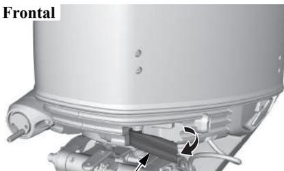
ENGANCHE DE LA CUBIERTA DEL MOTOR
