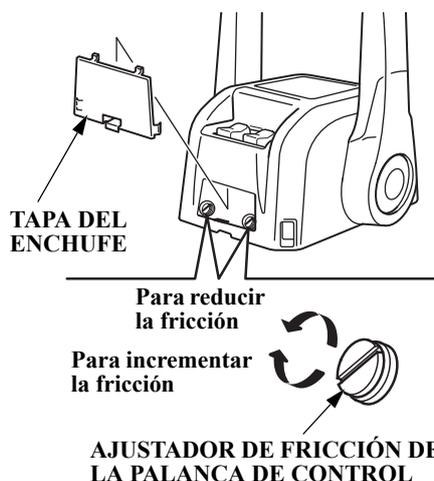
Compruebe si la palanca de control remoto se mueve bien. La fricción de la palanca de control remoto puede ajustarse girando el ajustador de fricción de la palanca de control a la derecha o a la izquierda.
