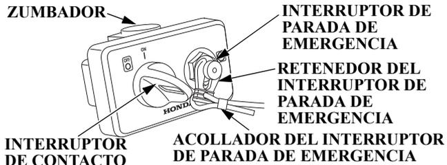
(Tipo llave normal sin interruptor de ENCENDIDO/PARADA) (Tipo horizontal)
