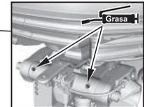
Aplique grasa también en la parte posterior de la placa de bloqueo de la cubierta del motor.
