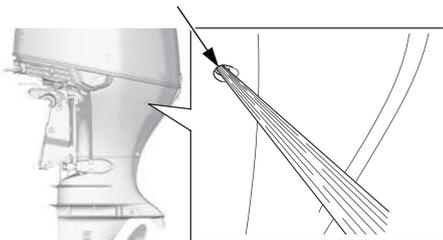
Aquí se comprueba si el agua de refrigeración circula adecuadamente dentro del motor.
