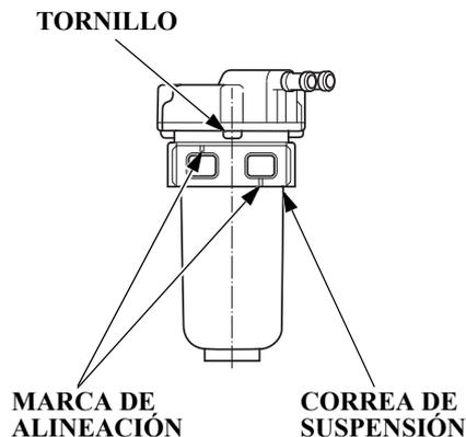
8. Al instalar la correa de suspensión en el filtro de combustible con separador de agua, alinee la marca de alineación tal como se muestra en la figura.
