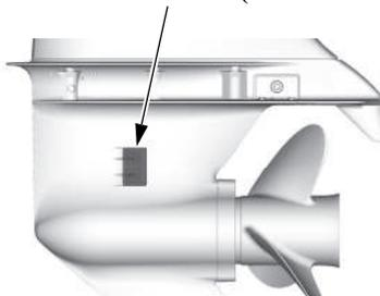
El agua de refrigeración del motor entra en el motor a través de este orificio.
