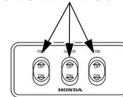
1. Presione la parte DN (abajo) del interruptor de trimado/inclinación motorizados y efectúe el trimado del motor fueraborda a la posición más baja.
