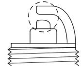
8. Inspeccione las bujías.
