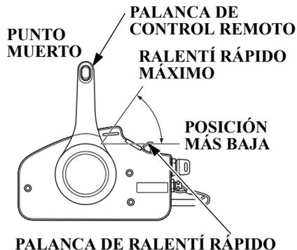
La palanca de ralentí rápido no se moverá a menos que la palanca de control remoto esté en la posición PUNTO MUERTO. A la inversa, la palanca de control remoto no se moverá a menos que la palanca de ralentí rápido esté en la posición más baja.
