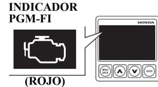
El indicador de PGM-FI se enciende y suena el zumbador cuando el sistema de control del motor está defectuoso.
