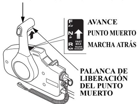
Cambiar a marcha adelante, marcha atrás o punto muerto y el ajuste de la velocidad del motor puede realizarse con la palanca de control remoto. Es necesario tirar de la palanca de liberación de punto muerto para operar la palanca de control remoto.
