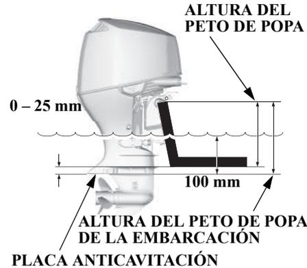
La placa anticavitación del motor fueraborda debe estar 0 – 25 mm por debajo de la parte inferior de la embarcación.
