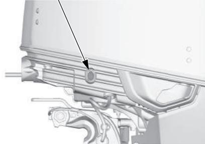
Cuando esté apartado del interruptor de trimado/inclinación motorizados en el lado de la palanca de control, podrá operar el interruptor de inclinación motorizados en el lado del motor fueraborda. La operación del interruptor es la misma que la del interruptor de trimado/inclinación motorizados del lado de la palanca de control remoto.
