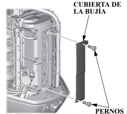
3. Extraiga los dos pernos con la llave hexagonal de 6 mm y retire la cubierta de la bujía.
