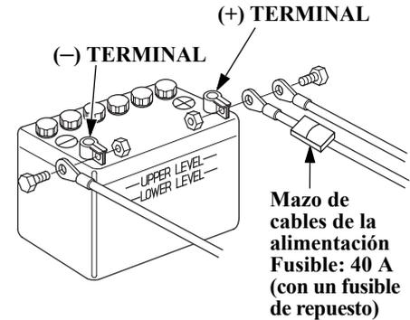
1. Desconecte el cable de a batería en el terminal negativo de la misma (-) y luego en el terminal positivo de la batería (+).
