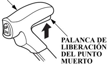
La palanca de liberación de punto muerto está puesta en la palanca de control remoto para impedir un accionamiento involuntario de la palanca de control remoto. La palanca de control remoto no funcionará a menos que sea movida mientras se empuja la palanca de liberación de punto muerto hacia arriba.
