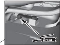
**PLACA DE BLOQUEO DE LA CUBIERTA DEL MOTOR**
