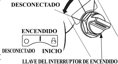
En el tipo de montaje lateral (tipo R1), el interruptor de encendido está situado a su lado cerca de la caja de control remoto. En el tipo montaje empotrado (tipo R2) y el tipo montaje superior (tipo R3), el interruptor de encendido está situado en el centro del panel de interruptores.
