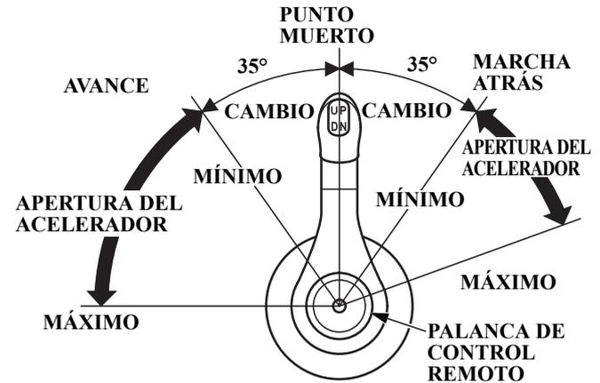
Cambiar a marcha adelante, marcha atrás o punto muerto y el ajuste de la velocidad del motor puede realizarse con la palanca de control remoto. Es necesario tirar de la palanca de liberación de punto muerto para operar la palanca de control remoto.
