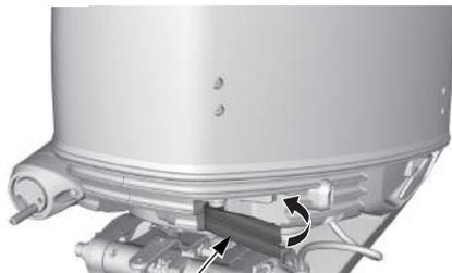
ENGANCHE DE LA CUBIERTA DEL MOTOR
