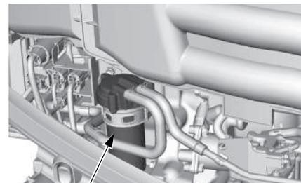
El filtro de combustible con separador de agua se encuentra debajo del colector de admisión. Compruebe si hay agua acumulada en el filtro de combustible con separador de agua. Si hay agua acumulada, realice el drenaje (vea la página 136).
