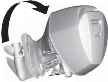
Incline hacia arriba el motor fueraborda con la palanca de bloqueo de inclinación cuando la embarcación esté amarrada. Cambie la palanca de control remoto a la posición PUNTO MUERTO y pare el motor antes de inclinar hacia arriba el motor fueraborda.
