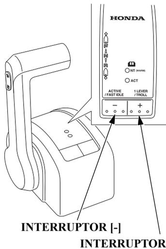
Los interruptores de función se utilizan para realizar operaciones en el modo de ralentí rápido, modo de pesca segura, modo monopalanca y modo de selección de estación.
