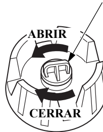
TAPA DE RELLENO DE COMBUSTIBLE PERILLA DE VENTILACIÓN
