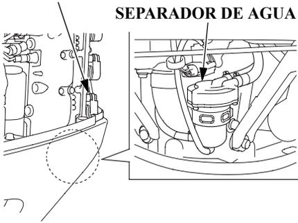
El separador de agua está situado debajo de la bobina de encendido del cilindro N° 6. La acumulación de agua en el separador de agua puede causar pérdidas de potencia o dificultad en el arranque. Compruebe periódicamente el separador de agua. Límpielo o consulte a un concesionario de motores fueraborda para realizar la limpieza.
