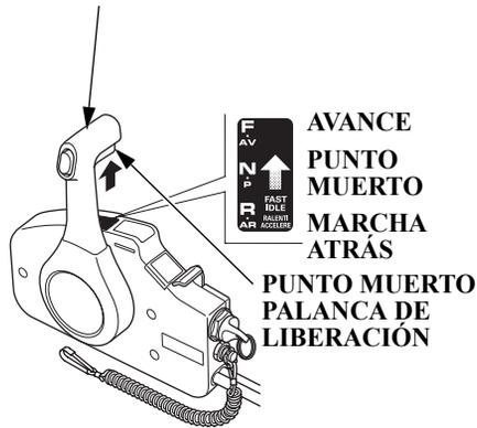
Cambiar a marcha adelante, marcha atrás o punto muerto y el ajuste de la velocidad del motor puede realizarse con la palanca de control remoto.
