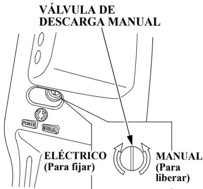
Si el interruptor de trimado/inclinación motorizados no hace inclinar el motor fueraborda, podrá inclinar manualmente el motor fueraborda hacia arriba o hacia abajo abriendo la válvula de descarga manual. Para inclinar manualmente el motor fueraborda, gire la válvula de alivio manual, de debajo de la ménsula de popa izquierda, no más de 1 o 2 vueltas hacia la izquierda empleando un destornillador.
