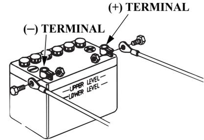
1. Desconecte el cable de a batería en el terminal negativo de la misma (-) y luego en el terminal positivo de la batería (+).
