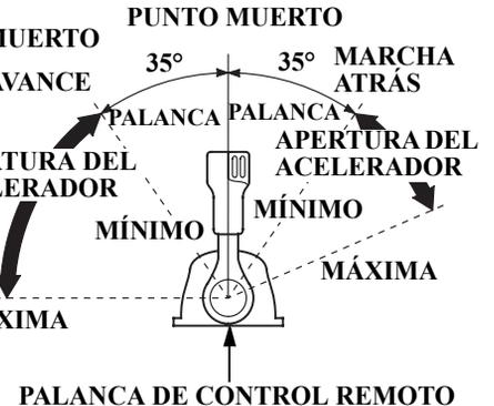
Cambiar a marcha adelante, marcha atrás o punto muerto y el ajuste de la velocidad del motor puede realizarse con la palanca de control remoto.
