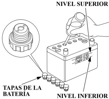
3. Llene la batería con agua destilada hasta la línea de nivel superior. Nunca llene demasiado la batería.
