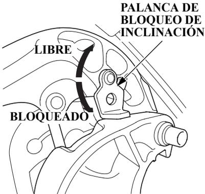
Emplee la palanca de bloqueo de la inclinación para elevar el motor fueraborda y bloquearlo en la posición cuando la embarcación esté amarrada o se deje anclada durante períodos prolongados.
