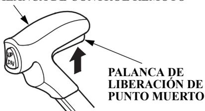
La palanca de liberación de punto muerto está puesta en la palanca de control remoto para impedir un accionamiento involuntario de la palanca de control remoto.
