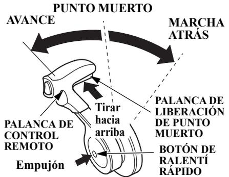
Presionando el botón de ralentí rápido, gire la palanca de control remoto hacia delante. Siga girando la palanca hacia delante. El acelerador se abrirá y la velocidad del motor aumentará después de que la palanca pase el punto de cambio.
