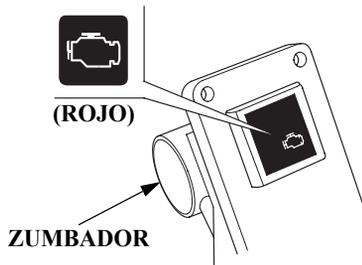
El indicador de PGM-FI se enciende y suena el zumbador cuando el sistema de control del motor está defectuoso.
