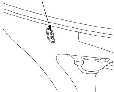
El interruptor de inclinación motorizada, situado en el cárter del motor fueraborda, es un práctico interruptor que permite inclinar el motor fueraborda para remolcarlo o para llevar a cabo su mantenimiento. Este interruptor de inclinación motorizada sólo deberá operarse cuando la embarcación esté parada y el motor desconectado.
