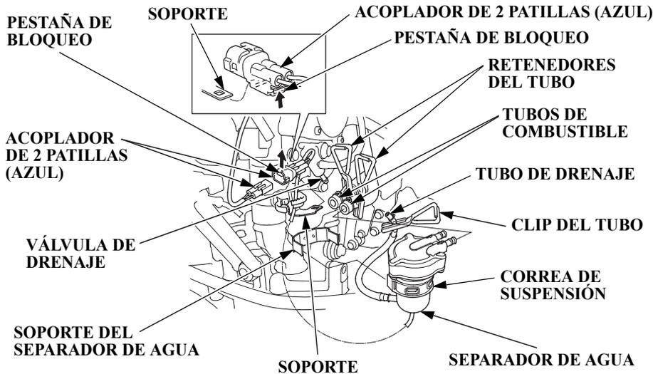
5. Desconecte el acoplador de 2 patillas (azul) presionando la pestaña de bloqueo.
