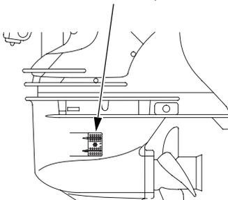
El agua de refrigeración del motor entra en el motor a través de este orificio.
