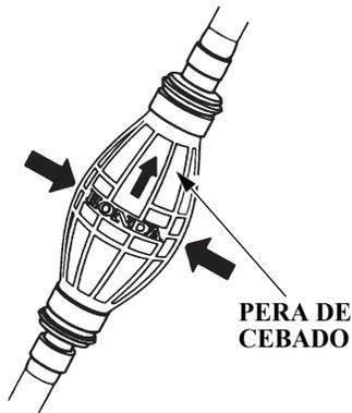
Sostenga la pera de cebado de modo que el extremo de salida esté más alto que el de entrada (de modo que la flecha de la pera de cebado señale hacia arriba), y bombéela hasta que note firmeza, lo cual es indicación de que el combustible ha llegado al motor fueraborda. Compruebe si hay fugas.
