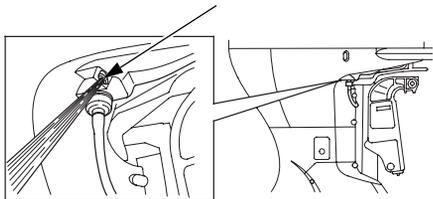
Aquí se comprueba si el agua de refrigeración circula adecuadamente dentro del motor.
