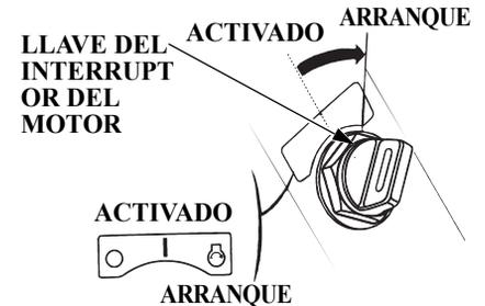
3. Gire la llave del interruptor del motor a la posición de arranque START y manténgala allí hasta que el motor arranque. Cuando el motor arranque, suelte la llave dejándola volver a la posición ON.
