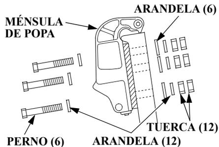
1. Aplique sellante de silicona (Three Bond 1216 o equivalente) a los orificios de fijación del motor fueraborda.
