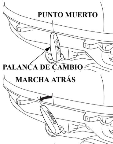
La palanca de cambios tiene tres posiciones: FORWARD (avance), NEUTRAL (punto muerto), y REVERSE (marcha atrás). El indicador que hay en la base de la palanca de cambios se alinea con el icono adherido a la base de la palanca de cambios.
