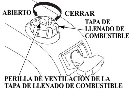
La perilla de ventilación de la tapa de relleno de combustible corta el paso del aire exterior hacia el depósito de combustible. Antes de operar el motor fuera borda, gire la perilla de ventilación de la tapa de relleno de combustible por lo menos 2 o 3 vueltas hacia la izquierda para abrir el respiradero.
