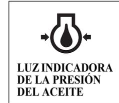
7. Después de haber arrancado el motor, confirme que se haya encendido la lámpara indicadora de la presión del aceite de motor. En el caso de que el indicador no esté encendido, pare el motor y efectúe las comprobaciones siguientes.
