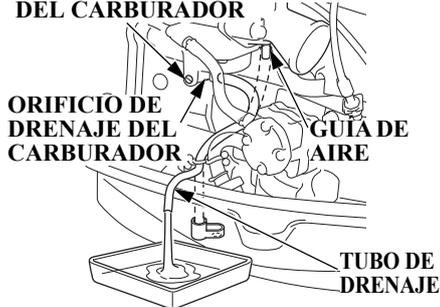
6. Afloje el tornillo de drenaje de carburador, y drene la gasolina en un recipiente adecuado.
