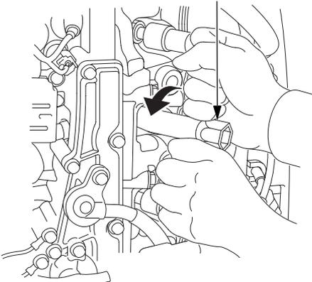
1. Desmonte la cubierta del motor.
