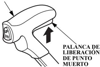
La palanca de liberación de punto muerto se ajusta en la palanca de control remoto para evitar el accionamiento accidental de la palanca de control remoto.
