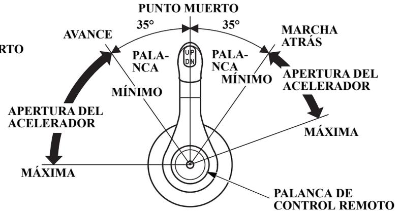
Cambiar a marcha adelante, marcha atrás o punto muerto y el ajuste de la velocidad del motor puede realizarse con la palanca de control remoto. Es necesario tirar de la palanca de liberación de punto muerto para operar la palanca de control remoto.
