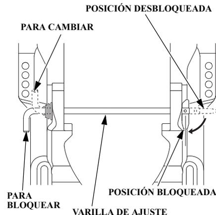
3. Introduzca la varilla de ajuste en el orificio correcto y dóblela hacia abajo para bloquear. Después del bloqueo, tire de la varilla de ajuste y cerciórese de que no está retraída.
