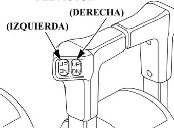
1. En el tipo T, presione DN (abajo) del interruptor de trimado/inclinación motorizados y efectúe el trimado del motor fueraborda a la posición más baja.
