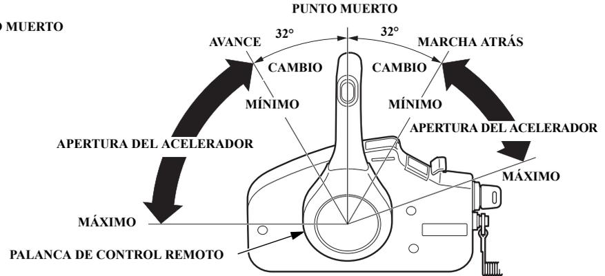
Con el cambio en posición de avance, marcha atrás o punto muerto, se puede realizar el ajuste del régimen del motor con la palanca de control remoto. Es necesario tirar hacia arriba de la palanca de liberación de punto muerto para activar la palanca de control remoto.
