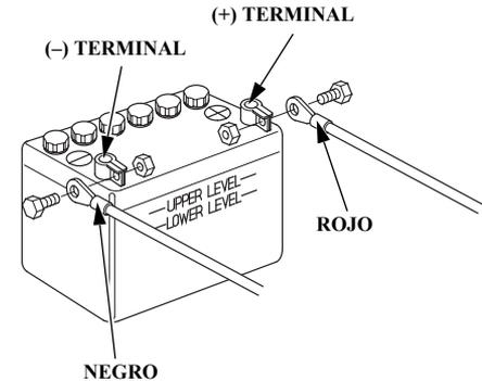
1. Desconecte el cable de la batería en el terminal negativo de la misma (-) y luego en el terminal positivo de la batería (+).
