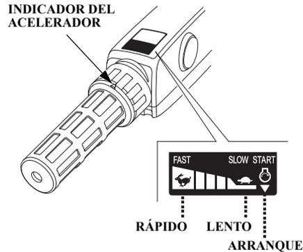
La curva de la empuñadura indica el régimen del motor.
