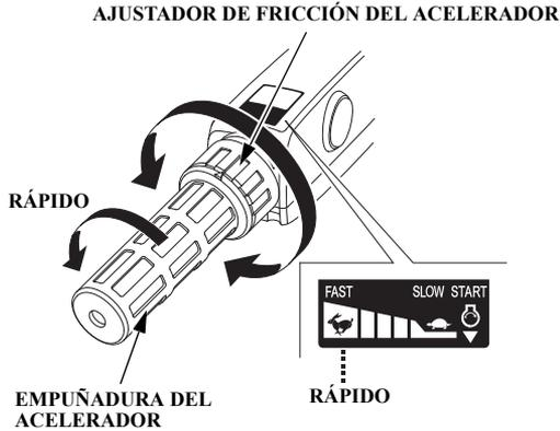
3. Gire la empuñadura del acelerador en la dirección RÁPIDO para aumentar la velocidad.
