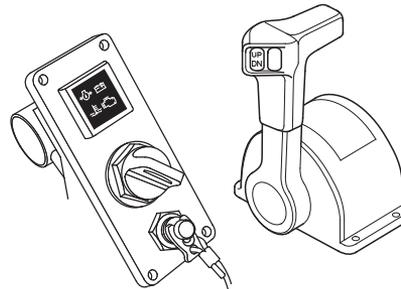
CAJA DE CONTROL Y PANEL DE INTERRUPTORES PARA TIPO DE MONTAJE EN PANEL
