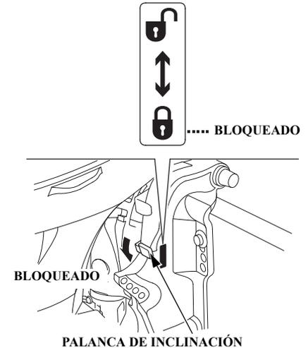
3. Con el motor fueraborda inclinado hacia arriba a la posición designada, mueva la palanca de inclinación a la posición BLOQUEADO para fijar el motor fueraborda en la posición.
