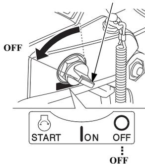
2. Gire la llave del interruptor del motor a la posición OFF para parar el motor.
