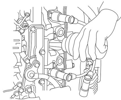
5. Introduzca una cucharada de aceite de motor en el orificio de cada bujía, y tire varias veces de la cuerda de arranque de emergencia para lubricar el interior de los cilindros. Vuelva a instalar las bujías.
