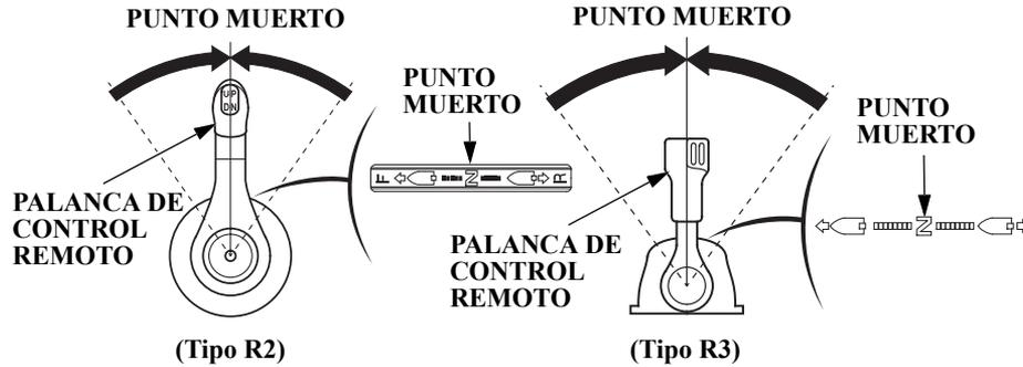
2. Coloque la palanca de control remoto en la posición de PUNTO MUERTO.
