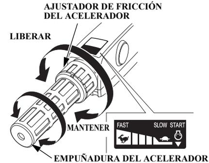
El ajustador de la fricción del acelerador ajusta la resistencia a la rotación de la empuñadura del acelerador.
