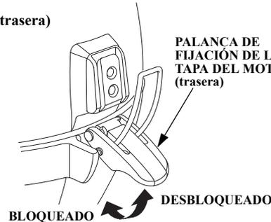
Cierre/abra la palanca de fijación de la tapa del motor para instalar o extraer la tapa del motor.
