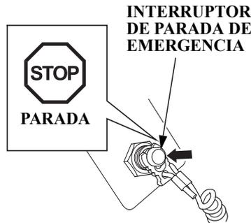
Presione el interruptor de parada de emergencia para detener el motor.
