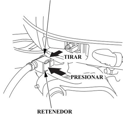
1. Mientras presiona el retenedor del conector de la línea de combustible, tire del conector de la línea de combustible y desconéctelo de la junta del lado del fueraborda.
