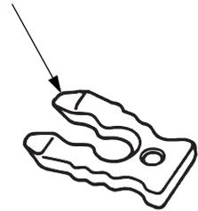
Guarde el retenedor del interruptor de parada de emergencia de repuesto en la bolsa de herramientas.
