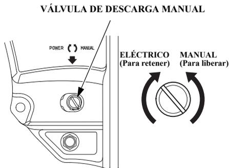
Cuando el sistema de trimado/inclinación motorizados no opera debido a que se ha descargado la batería o a una avería del motor de trimado/inclinación motorizados, podrá inclinar manualmente el motor fueraborda hacia arriba o abajo operando la válvula de descarga manual. Para inclinar manualmente el motor fueraborda, gire la válvula de descarga manual, de debajo de la ménsula de popa, dos vueltas y media hacia la izquierda empleando un destornillador.
