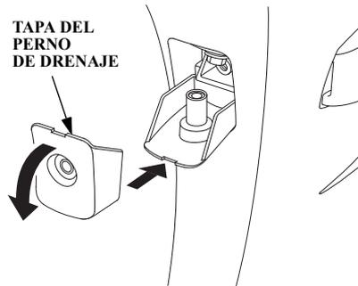
3. Ponga la cubierta del perno de drenaje como se muestra para emplearla como guía del aceite de drenaje. Coloque un recipiente adecuado debajo de la guía.
