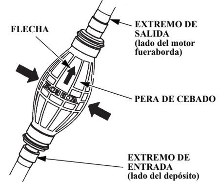
Sostenga la pera de cebado de modo que el extremo de salida esté más alto que el de entrada (de modo que la flecha de la pera de cebado señale hacia arriba), y bombéela hasta que note firmeza, lo cual es indicación de que el combustible ha llegado al motor fueraborda. Compruebe si hay fugas.
