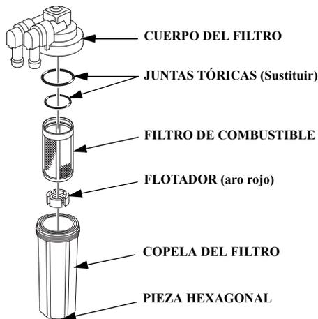
3. Gire la pieza hexagonal hacia la izquierda y separe la copela del cuerpo del filtro.
