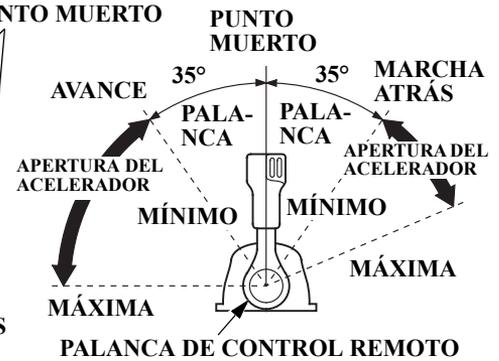
Cambiar a marcha adelante, marcha atrás o punto muerto y el ajuste de la velocidad del motor puede realizarse con la palanca de control remoto.
