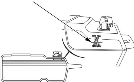
Compruebe el medidor de combustible, y llene el depósito hasta la marca de nivel superior si es necesario. No llene el depósito de combustible por encima de la marca de nivel superior UPPER.
