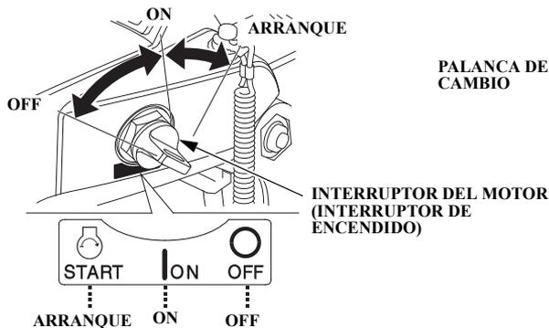
Esta manija de la caña del timón está equipada de un interruptor de encendido del tipo de automóvil.
