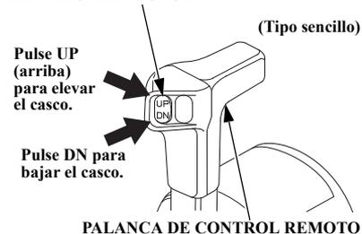
INTERRUPTOR DE INCLINACIÓN Y TRIMADO DEL MOTOR (DERECHA)
