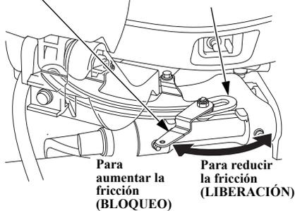
Compruebe si la caña se mueve bien. Para poder controlar con suavidad el rumbo, ajuste el ajustador de la fricción del timón de modo que note un poco de arrastre al efectuar giros.
