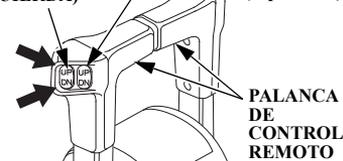
Pulse buen UP (arriba) o DN (abajo) del interruptor de trimado/inclinación e incline el motor fueraborda hasta la mejor posición según de las condiciones de navegación.
