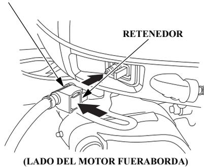
2. Conecte el conector de la línea de combustible al motor fueraborda, como se indica. Asegúrese que el conector de la línea de combustible está firmemente encajado en su lugar.
