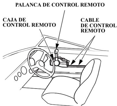
Instale la caja de control remoto en la posición en que sea más fácil para accionar la palanca de control remoto y los interruptores.
