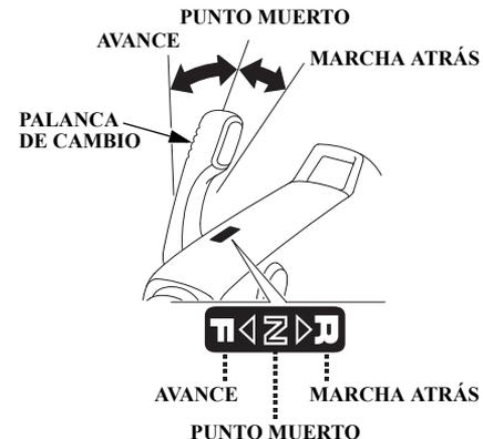
Utilice la palanca de cambios para hacer marchar la embarcación hacia adelante o hacia atrás, o para cortar la potencia del motor a la hélice. La palanca de cambios tiene tres posiciones.
