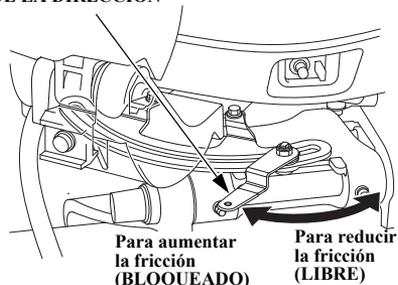
Cuando remolque o transporte la embarcación con el motor fueraborda montado, desconecte siempre la línea de combustible del depósito de combustible portátil y mueva la palanca de fricción de la dirección a la posición bloqueada (vea la página 67).
