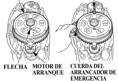
7. Coloque el rotor del ACG de modo que la flecha esté alineada con el motor de arranque como se muestra. Enganche el nudo de la cuerda del arrancador al corte de popa como se muestra arriba a la derecha. Bobine la cuerda del arrancador de 160 cm 3 vueltas (hacia la izquierda) alrededor del rotor del ACG.
