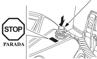
Presione el interruptor de parada de emergencia para detener el motor.
