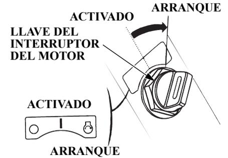
3. Gire la llave del interruptor del motor a la posición de arranque START y manténgala allí hasta que el motor arranque.
