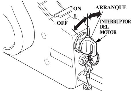
Este control remoto está equipado con un interruptor de encendido del tipo llave. En el tipo de montaje lateral (tipo R1), el interruptor del motor está situado a su lado cerca de la caja de control remoto. En el tipo de montaje en panel (tipo R2) y tipo de montaje superior (tipo R3), el interruptor del motor está situado en el panel de interruptores.
