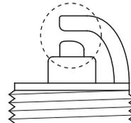
4. Inspeccione las bujías.
