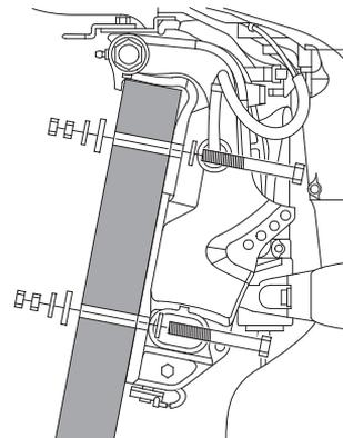
3. Fije el motor fueraborda en un soporte de motor fueraborda con los pernos y las tuercas de montaje.
