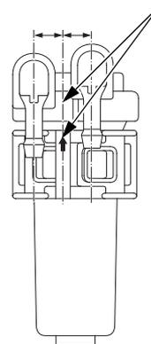
6. Instale la correa de suspensión en el conjunto del filtro de combustible como se muestra arriba.
