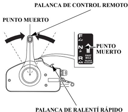
2. Coloque la palanca de control remoto en la posición de punto muerto. El motor no arranca a menos que la palanca de control remoto se encuentra en la posición de PUNTO MUERTO.
