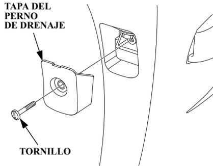
2. Afloje el tornillo de la cubierta del perno de drenaje con un destornillador de punta plana y extraiga la cubierta del perno de drenaje.
