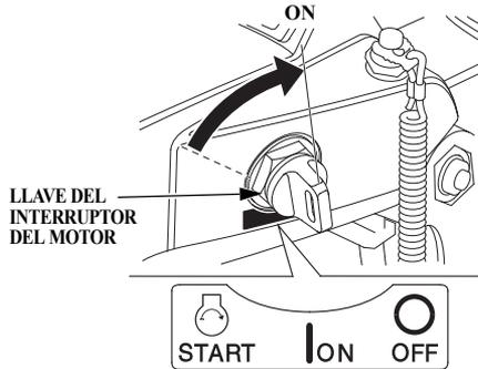
9. Gire la llave del interruptor del motor a la posición ON.
