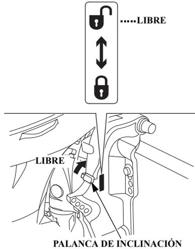
4. Para hacer retornar el motor fueraborda, mueva la palanca de inclinación a la posición FREE, incline un poco el motor fueraborda hacia arriba agarrando la empuñadura de la tapa del motor y bájelo con suavidad a la posición designada.
