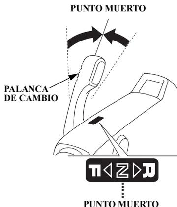
1. Gire la empuñadura del acelerador a la posición LENTO y mueva la palanca de cambios a la posición de PUNTO MUERTO.
