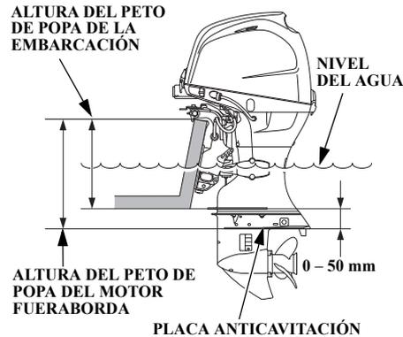
La placa anticavitación del motor fuera debe estar 0 – 50 mm por debajo del fondo de la embarcación.
