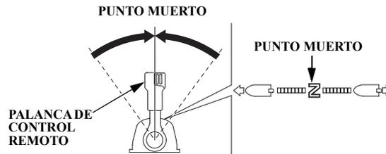
5. Ponga la palanca de cambios o la palanca de control remoto en la posición NEUTRAL (punto muerto).
