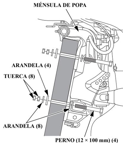
1. Aplique sellante de silicona (Three Bond 1216 o equivalente) a los orificios de fijación del motor fueraborda.
