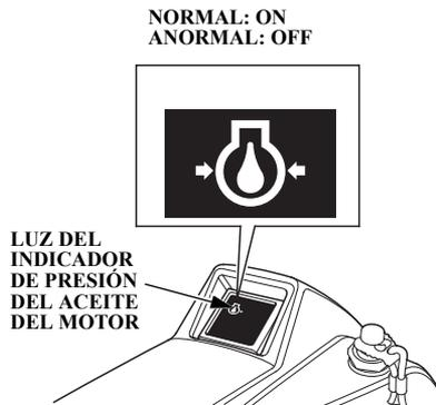
6. Compruebe para ver si la luz del indicador de presión del aceite pasa a posición ON.
