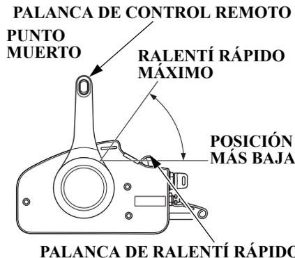
La palanca de ralentí rápido no se moverá a menos que la palanca de control remoto esté en la posición NEUTRAL. A la inversa, la palanca de control remoto no se moverá a menos que la palanca de ralentí rápido esté en la posición más baja.
