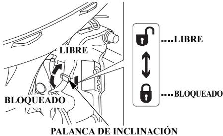
Utilice la palanca de inclinación para elevar temporalmente el motor fueraborda cuando la embarcación está navegando en aguas poco profundas, o para amarrar o echar el ancla en aguas poco profundas.
