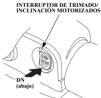
1. En el tipo T, presione la parte DN (abajo) del interruptor de trimado/ inclinación motorizados y efectúe el trimado del motor fueraborda a la posición más baja.
