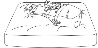
Cuando coloque el motor fueraborda horizontalmente para el transporte, asegúrese de colocar esponja o paños debajo del motor para protegerlo contra golpes y otros daños.
