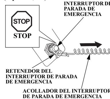
Para parar el motor en un caso de emergencia, tire del retenedor del interruptor de parada de emergencia para sacarlo del interruptor de parada de emergencia tirando del acollador del interruptor de parada de emergencia. Le aconsejamos que de vez en cuando pare el motor de esta forma para verificar la correcta operación del interruptor de parada de emergencia.
