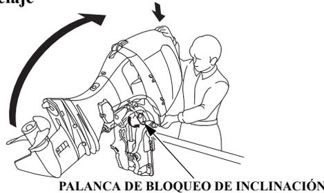
Incline hacia arriba el motor fueraborda con la palanca de bloqueo de inclinación cuando la embarcación esté amarrada. Cambie la palanca de cambios o la palanca de control remoto a la posición de PUNTO MUERTO y pare el motor antes de inclinar hacia arriba el motor fueraborda.
