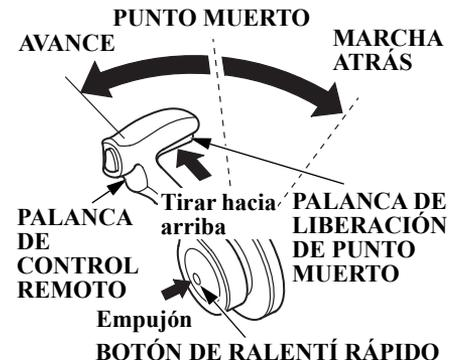
Presionando el botón de ralentí rápido, gire la palanca de control remoto hacia delante. Siga girando la palanca hacia delante. El acelerador se abrirá y la velocidad del motor aumentará después de que la palanca pase el punto de cambio.
