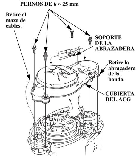
3. Extraiga los cuatro pernos de 6 x 25 mm y el soporte de la abrazadera, y luego extraiga la cubierta del ACG.
