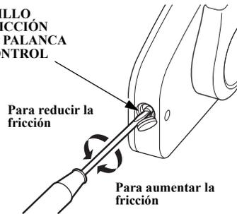
Compruebe si la palanca de control remoto se mueve suavemente. La fricción de la palanca de control se puede ajustar girando el ajustador de fricción de la palanca de control a derecha o izquierda.
