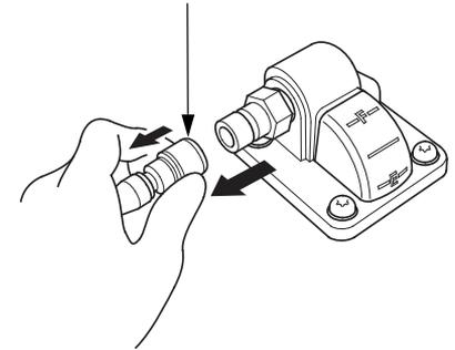
2. Mientras tira de la cubierta del conector de la línea de combustible, tire del conector de la línea de combustible para desconectarlo del depósito de combustible.
