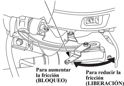
El ajustador de la fricción del timón ajusta la resistencia del timón.
