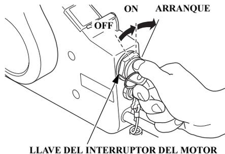
4. Gire la llave del interruptor del motor a la posición de arranque START y manténgala allí hasta que el motor arranque. Cuando el motor arranque, suelte la llave dejándola volver a la posición ON.
