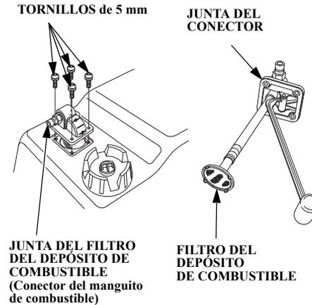
1. Extraiga los cuatro tornillos de 5 mm utilizando un destornillador de punta plana, luego extraiga el conector de la manguera de combustible y el filtro del depósito de combustible desde el depósito.
