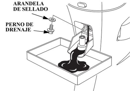
4. Extraiga el perno de drenaje de aceite de motor y arandela de sellado usando la llave de 12 mm y drene el aceite de motor.
