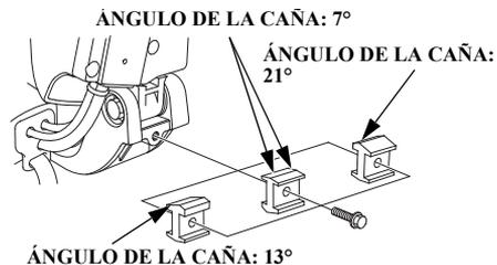
Instale bloque de ajuste de la altura para que el ángulo seleccionado de la caña del timón quede en esta posición.
