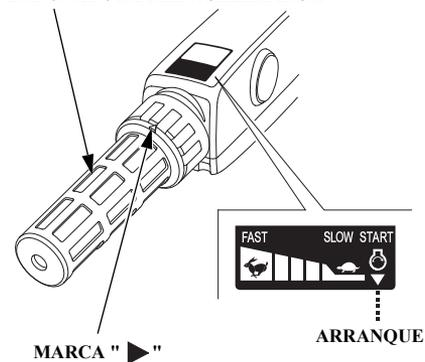
3. Alinee la marca "⌚" en el puño de admisión con el extremo proyectado de la marca "▶" de la barra.
