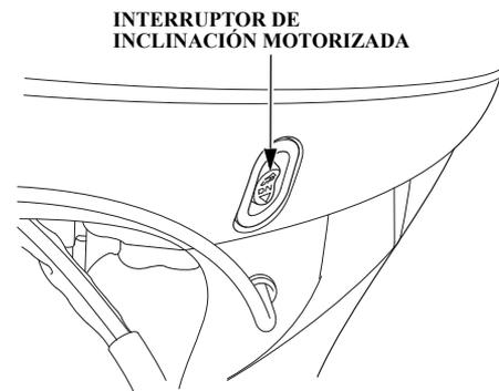
Cuando esté alejado del interruptor de trimado/inclinación motorizados del lado de la palanca de control, podrá operar el interruptor de inclinación motorizada del lado del motor fueraborda. La operación del interruptor es la misma que la del interruptor de trimado/inclinación motorizados del lado de la palanca de control.
