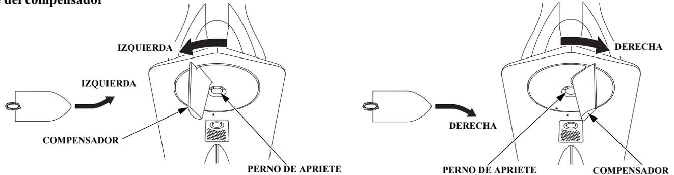
El compensador está provisto para "girar la dirección descentrada" que es una reacción de la rotación de la hélice o torsión de la hélice. Si durante un giro a alta velocidad se requiere un esfuerzo desigual para girar la embarcación hacia la derecha o izquierda, ajuste el compensador de modo que se requiera un esfuerzo equivalente.
