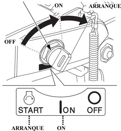
4. Gire la llave del interruptor del motor a la posición de arranque START y manténgala allí hasta que el motor arranque.
