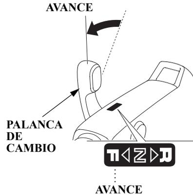
1. Con la palanca de cambios en la posición FORWARD (avance).
