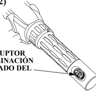
INTERRUPTOR DE INCLINACIÓN Y TRIMADO DEL MOTOR
