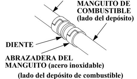
1. Extraiga el tapón de manguera de la manguera de combustible del lado del motor. Inserte la junta de la línea de combustible en la manguera de combustible del lado del motor y fijela con la abrazadera de la manguera. (El procedimiento es el mismo que en el caso de emplear uno del tipo equipado con depósito de combustible. Consulte la página anterior.)
