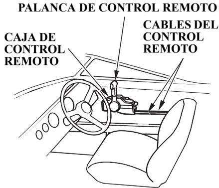
Instale la caja de control remoto en una posición en la que sea fácil de operar la palanca de control remoto y el interruptor.
