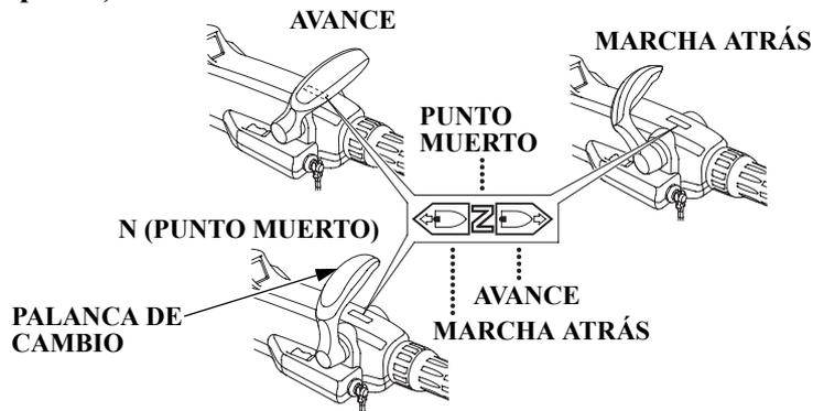
La palanca de cambios tiene 3 posiciones: FORWARD (avance), NEUTRAL (punto muerto), y REVERSE (marcha atrás). El indicador que hay en la base de la palanca de cambios se alinea con el icono adherido a la caña de timón.
