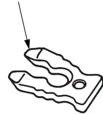
Guarde el retenedor del interruptor de parada de emergencia de repuesto en la bolsa de herramientas.
