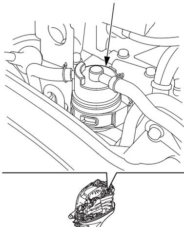
El filtro de combustible (dentro de la copela del filtro) está situado entre la bomba de combustible y el separador del agua.
