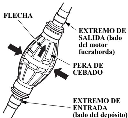
Sostenga la pera de cebado de modo que el extremo de salida esté más alto que el de entrada (de modo que la flecha de la pera de cebado señale hacia arriba), y bombéela hasta que note firmeza, lo cual es indicación de que el combustible ha llegado al motor fueraborda. Compruebe si hay fugas.
