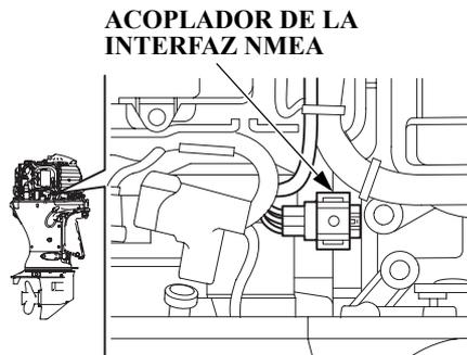
El acoplador de la interfaz NMEA2000 puede ofrecer información relativa al régimen del motor, consumo de energía y distintas advertencias a una red NMEA2000 existente por medio de un cable de interfaz opcional. Para obtener más información al respecto, póngase en contacto con su concesionario.
