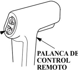
INTERRUPTOR DE INCLINACIÓN Y TRIMADO DEL MOTOR
