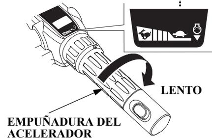
1. Alinee el indicador del timón con la posición LENTO de la empuñadura del acelerador para reducir la velocidad del motor.
