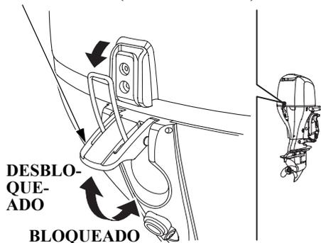
Cierre/abra la palanca de fijación de la tapa del motor para instalar o extraer la tapa del motor.
