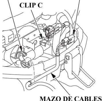
3. Abra el retenedor del mazo de cables y extraiga el mazo de cables del clip C, y desconecte entonces el conector de 2 patillas del sensor del nivel de agua.
