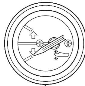
El medidor de trimado tiene un margen de  $-4^{\circ}$  a  $16^{\circ}$  e indica el ángulo de trimado del motor fueraborda. Mire el medidor de trimado cuando desee emplear el interruptor de trimado/inclinación motorizados para conseguir el rendimiento adecuado de la embarcación.
