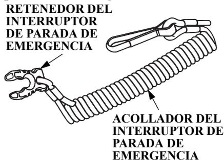
El cable del interruptor de parada de emergencia se incorpora para detener inmediatamente el motor cuando el operador se cae por la borda o lejos del motor fueraborda.
