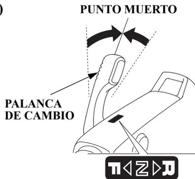
1. Gire la empuñadura del acelerador a la posición LENTO y mueva la palanca de cambios a la posición de PUNTO MUERTO.
