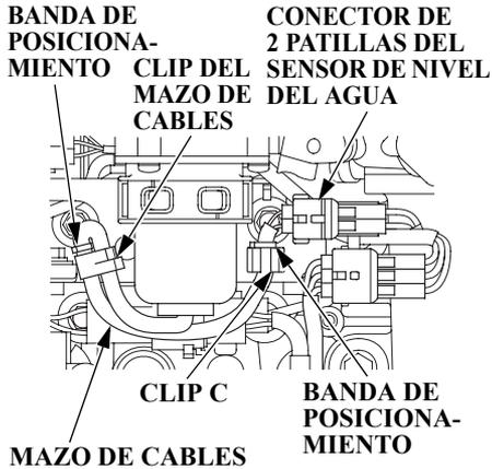
9. Conecte el conector de 2 patillas del sensor del nivel de agua. Instale el mazo de cables en el retenedor C y el retenedor del mazo de cables. Alinee las bandas de posicionamiento del mazo de cables con el extremo del retenedor C y el retenedor del mazo de cables como se muestra arriba.
