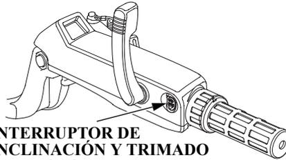
INTERRUPTOR DE INCLINACIÓN Y TRIMADO DEL MOTOR
