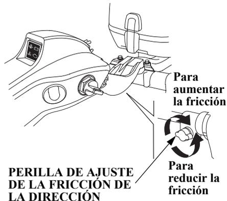
**PERILLA DE AJUSTE DE LA FRICCIÓN DE LA DIRECCIÓN**
