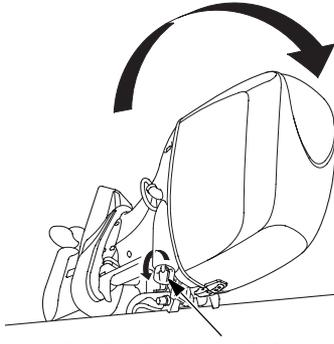
**PALANCA DE BLOQUEO DE INCLINACIÓN**
