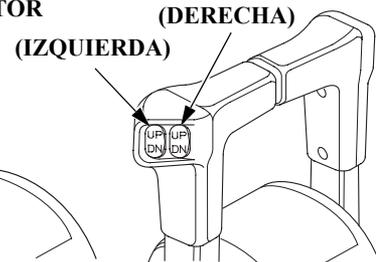
1. Presione DN (abajo) del interruptor de trimado/inclinación motorizados y efectúe el trimado del motor fueraborda a la posición más baja.
