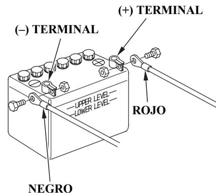
1. Desconecte el cable de a batería en el terminal negativo de la misma (-) y luego en el terminal positivo de la batería (+).
