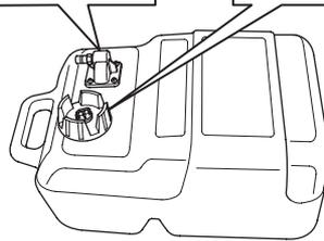
2. Conecte la línea de combustible al depósito. Asegúrese de que el conector esté enganchado con seguridad.
