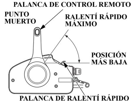
La palanca de ralentí rápido no se moverá a menos que la palanca de control remoto esté en la posición NEUTRAL. A la inversa, la palanca de control remoto no se moverá a menos que la palanca de ralentí rápido esté en la posición más baja.
