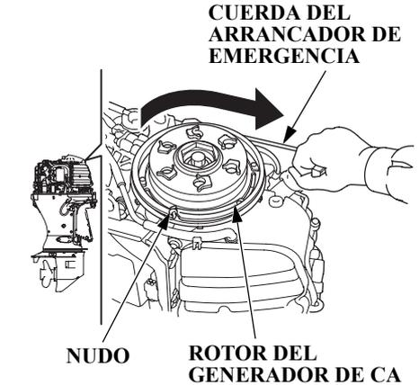
8. Coloque el rotor del generador de CA de modo que los cortes estén en los lados derecho e izquierdo del rotor del generador de CA como se muestra. Enganche el nudo del extremo de la cuerda del arrancador (accesorio) contra un corte del rotor del generador de CA y bobine la cuerda del arrancador una vuelta y media hacia la derecha a lo largo de la ranura del rotor del generador de CA.
