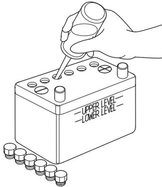
3. Llene la batería con agua destilada hasta la línea de nivel superior. Nunca llene en exceso la batería.
