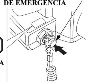
Presione el interruptor de parada de emergencia para detener el motor.
