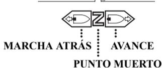
Utilice la palanca de cambios para hacer marchar la embarcación hacia adelante o hacia atrás, o para cortar la potencia del motor a la hélice. La palanca de cambios tiene tres posiciones.
