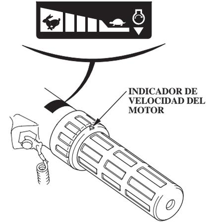
La curva de la etiqueta de la empuñadura indica la velocidad del motor.
