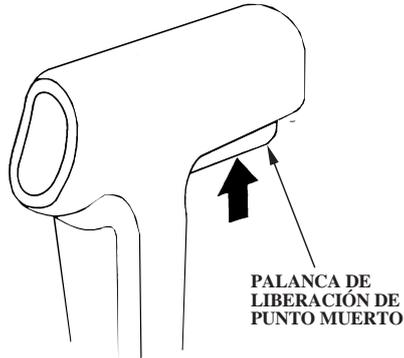
La palanca de liberación de punto muerto se ha colocado en la palanca de control remoto para evitar la operación accidental de la palanca de control remoto.
