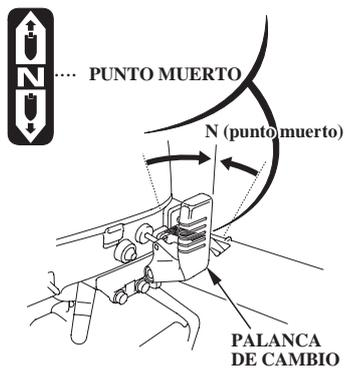
1. Mueva la palanca de cambios o la palanca de control a la posición N (punto muerto) y pare el motor.
