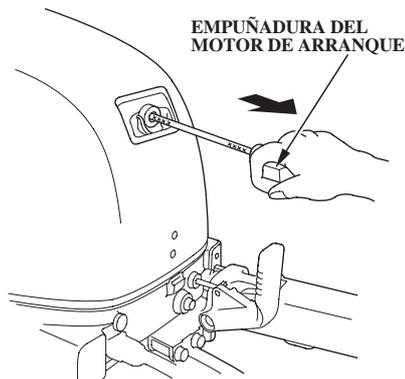
Al tirar de la empuñadura del arrancador se acciona el arrancador de retroceso para virar y poner en marcha el motor. Ponga la palanca de cambios en la posición N (punto muerto) antes de arrancar.
