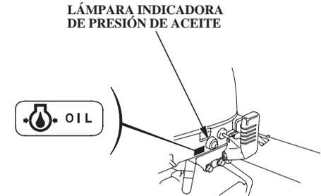
Cuando el nivel del aceite de motor sea bajo o cuando el sistema de lubricación del motor esté defectuoso, se apaga la luz indicadora de la presión del aceite.
