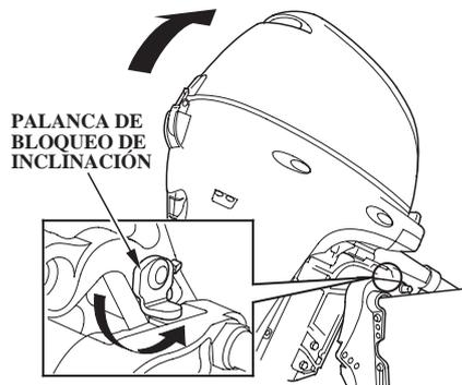
Inclinación usando la palanca de bloqueo de inclinación.
