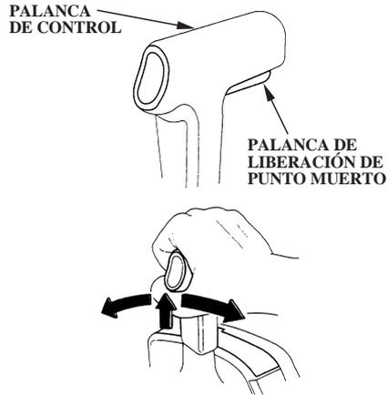
Mientras tira de la palanca de liberación de punto muerto, mueva la palanca de control 30° hacia la posición de AVANCE o de MARCHA ATRÁS para aplicar el embrague. Moviéndola más abre la admisión todavía más y la velocidad del motor aumenta.
