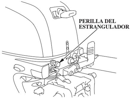
Si la perilla del estrangulador retorna por sí misma a la posición OFF, podrá ajustar la fricción que retiene la perilla en la posición ON.
