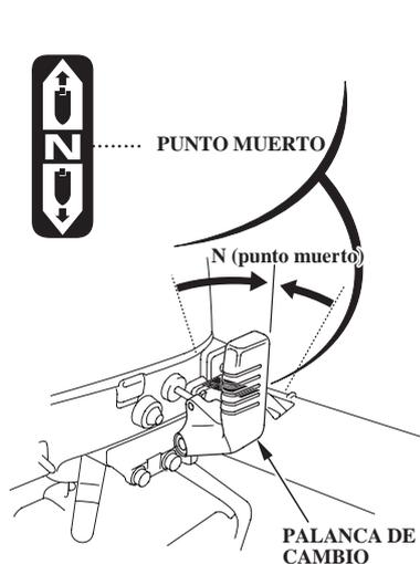
1. Mueva la palanca de cambios a la posición N (punto muerto) y pare el motor.
